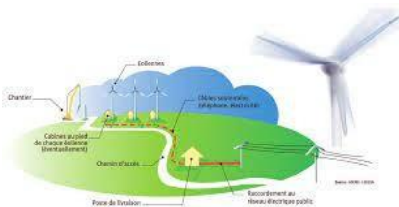
Figure 5 : Schéma de principe d'un parc éolien – Source : CEREMA
